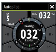
Wenn Ihr Zeus<sup>2</sup> an ein Autopilot-System mit einer AP24- bzw. AP28-Steuereinheit verbunden ist, kann immer nur eine Steuereinheit gleichzeitig aktiv sein. Eine inaktive Steuereinheit wird im Pop-up-Fenster für die Autopilot-Steuerung mit einem Symbol dargestellt, das wie ein angekreuztes Kästchen aussieht.
