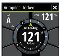
Die AP24/AP28 bietet eine Funktion zum Sperren dezentraler Stationen, mit der die Autopilot-Steuerung über andere Steuereinheiten unterbunden wird. Eine gesperrte Steuereinheit erkennen Sie an dem Schlüsselsymbol im Pop-up-Fenster für die Autopilot-Steuerung.
